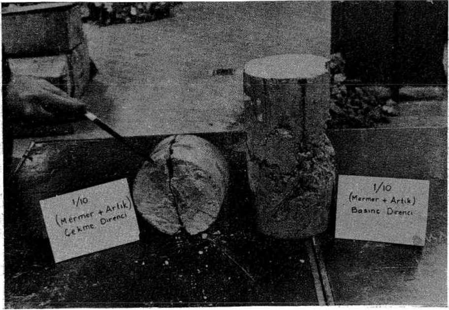
Şekil 1: Deneylerde Gözlenen Tipik Kırılma Modları
