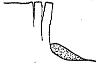
e) Gerilim çatlağından doğan devrilme
