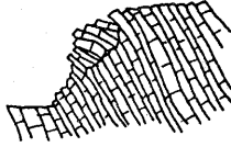
b) Blok devrilmesi
