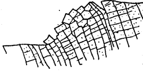
c) Blok - büküme devrilmesi
