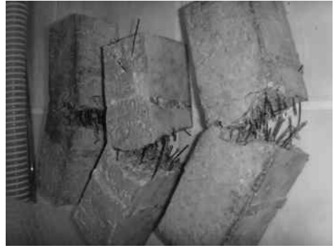
Şekil 13. Polimer fiberli, kırılmış eğilme dayanımı numuneleri.
