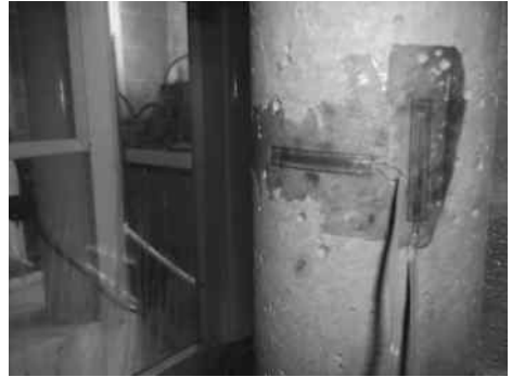
Şekil 7. Birim deformasyon ölçer yapılandırılmış numune.
