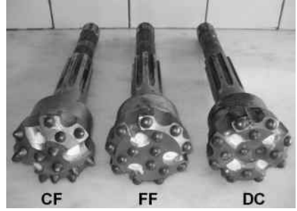
Şekil 4. Çalışmada kullanılan delici uçlar.
