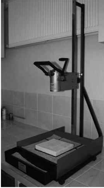
Şekil 2. Çarpma dayanımı deneyi test cihazında mermer numunelerinin testi.
