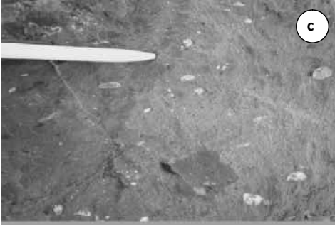
Şekil 1. Çalışmada kullanılan afanitik (a), vesiküler (b) ve amigdaloidal (c) dokulu bazaltlar.
