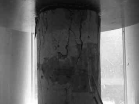
Şekil 9. Tek eksenli basınç altındaki deformabilite deneyi numunesi.
