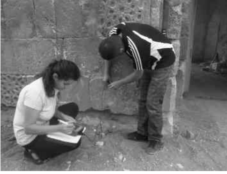
Şekil 2. Equotip sertlik cihazı ile ölçüm.
