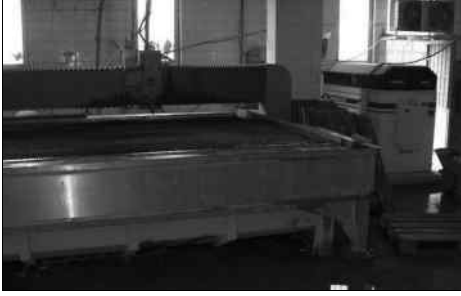
Şekil 2. Çalışmada kullanılan aşındırıcı su jeti kesme makinesi.
