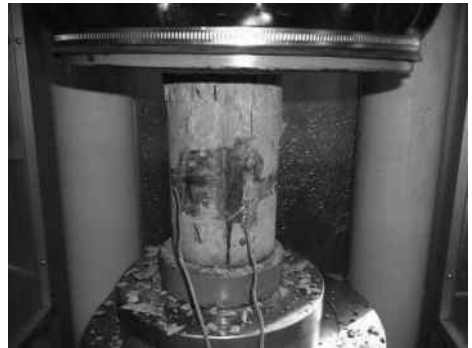
Şekil 8. Tek eksenli basınç altında kırılmış deformabilite deneyi numunesi.
