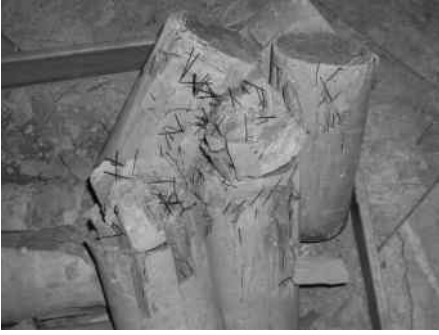
Şekil 6. Kırılmış polimerli beton numuneleri.
