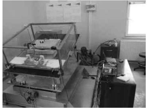
Şekil 3. Sarsma masası ve fiziksel model deney düzeneği.
