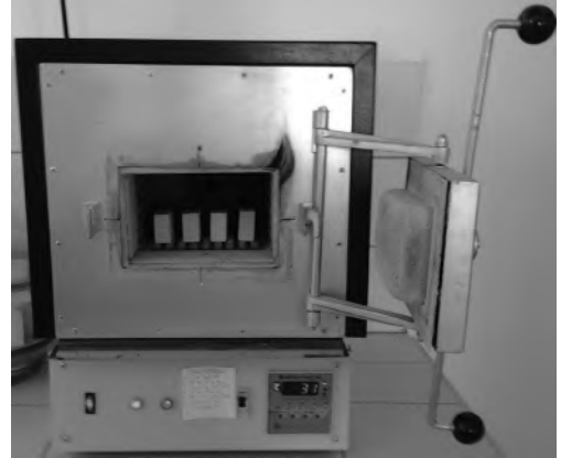
Şekil 2. Numunelerin farklı sıcaklıklarda kondisyonlanmasında kullanılan fırın
