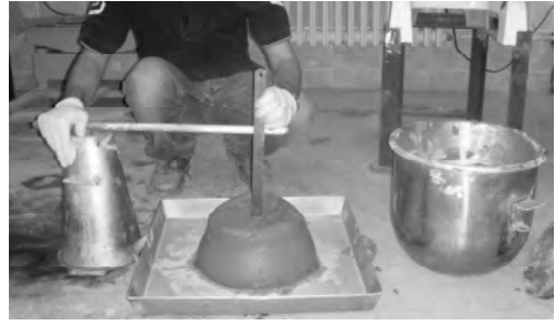
Şekil 3. Karışımlara yapılan çökme değeri testi
