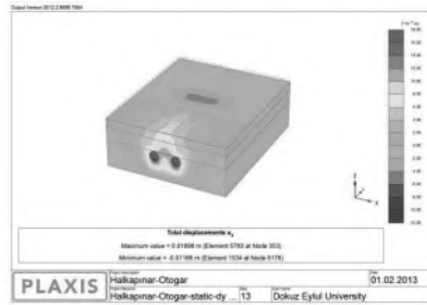
Şekil 10. Halkapınar-Otogar TBM Tüneli düşey deformasyonların görünümü (Aksoy vd., 2013)
