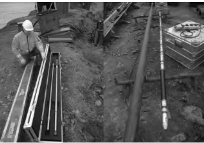
Şekil 12. Akustik/Optik Kuyu içi Kamerası
