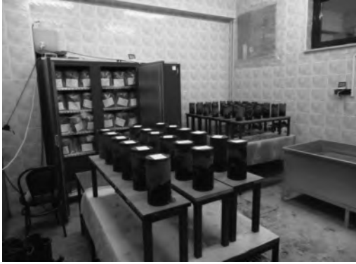
Şekil 2. Macun dolgu numunelerinin kür dolabında kür işlemine tabii tutulması
