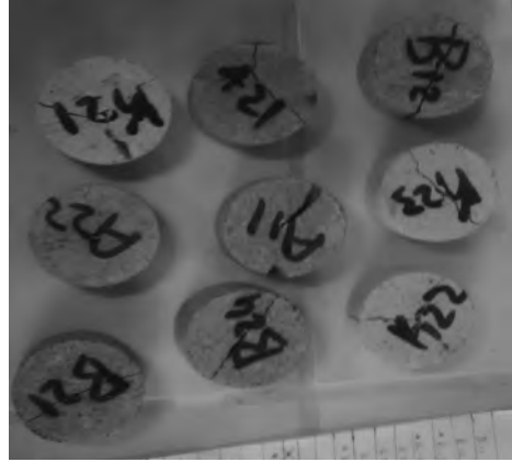
Şekil 6. Nokta yükleme dayanım sonucunda örnekler.
