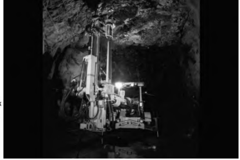
Şekil 9. Tam mekanize uygulama (Boltec)
