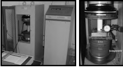
Şekil 4. Autotest 3000 model hidrolik test presi ve test öncesi bir görünüm.
