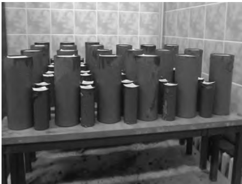
Şekil 2. Macun dolgu numunelerinin görünümü
