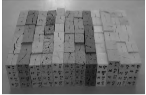
Şekil 8. Çalışma kapsamında nokta yük dayanım deneyinde kullanılan numunelerin deney sonrası görüntüleri
