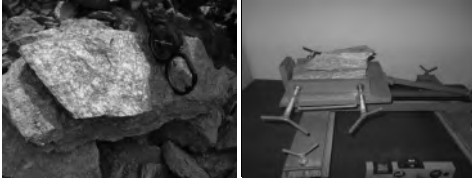
Şekil 11. Arazide ve laboratuvar ortamında yapılan sürtünme açısı belirleme deneyleri.
