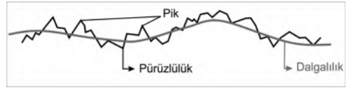
Şekil 2. Pürüzlülük, dalgalılık ve pik sayısı
