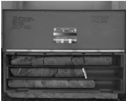
Şekil 11: PQ Çaplı Karot Sandığı
