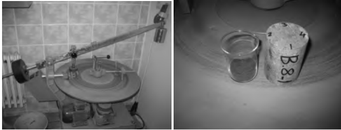
Şekil 2. Böhme yüzey aşındırma deney düzeneği
