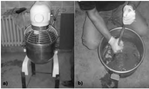
Şekil 2. 20 lt'lik mikser (a), karışıma su ilavesi (b)
