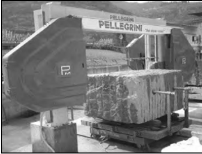
Şekil 1. Doğal taş işletmeciliğinde kullanılan tektelli kesme makineleri (monoteller) (Pellegrini Meccanica, 2013)
