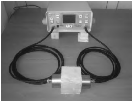
Şekil 2. Ultrasonik P-dalga hızı ölçüm cihazı
