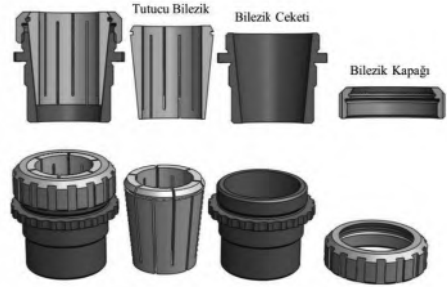
Şekil 5 Karot tutma mekanizmasının bileşenleri.
