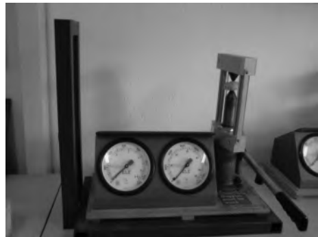
Şekil 3. Nokta yük dayanım indeksi tayini deney aleti
