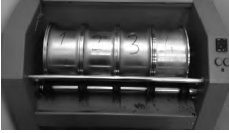
Şekil 3. Mikro-Deval aşındırma cihazı
