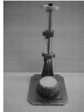
Şekil 3. Taze harcın Vicat iğne yöntemiyle priz ölçümü.
