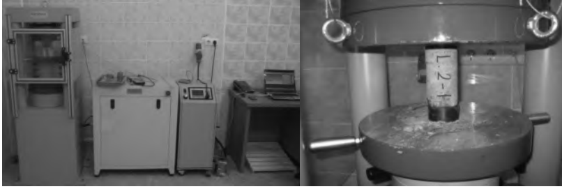
Şekil 4. Tek eksenli basma dayanımı deney aleti ve numunenin yerleştirmesi
