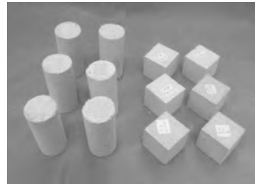
Şekil 1. Doğal bileşenli suni taş test örnekleri.
