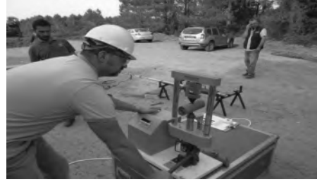
Şekil 15. Sahada Nokta Yükleme Deneyi
