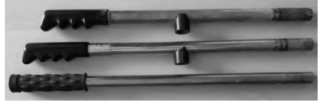
Şekil 2. Farklı deney aletlerine ait yükleme kolları
