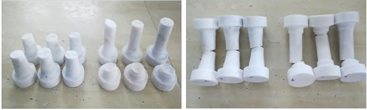
Şekil 8. Numunelerde gerçekleşen kırılma bölgeleri
