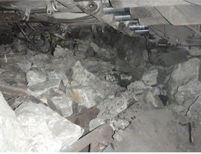
Şekil 21. G-02/2 panosunda oluşan göçükten bir görüntüler (Ünver vd. 2009).
