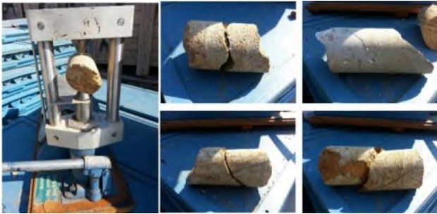
Şekil 2. Nokta yük dayanım indeksi deneyi ve kırılmış numuneler
