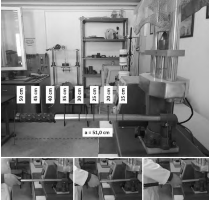
Şekil 4. Farklı yüklem kolu boyları için tutuş pozisyonları
