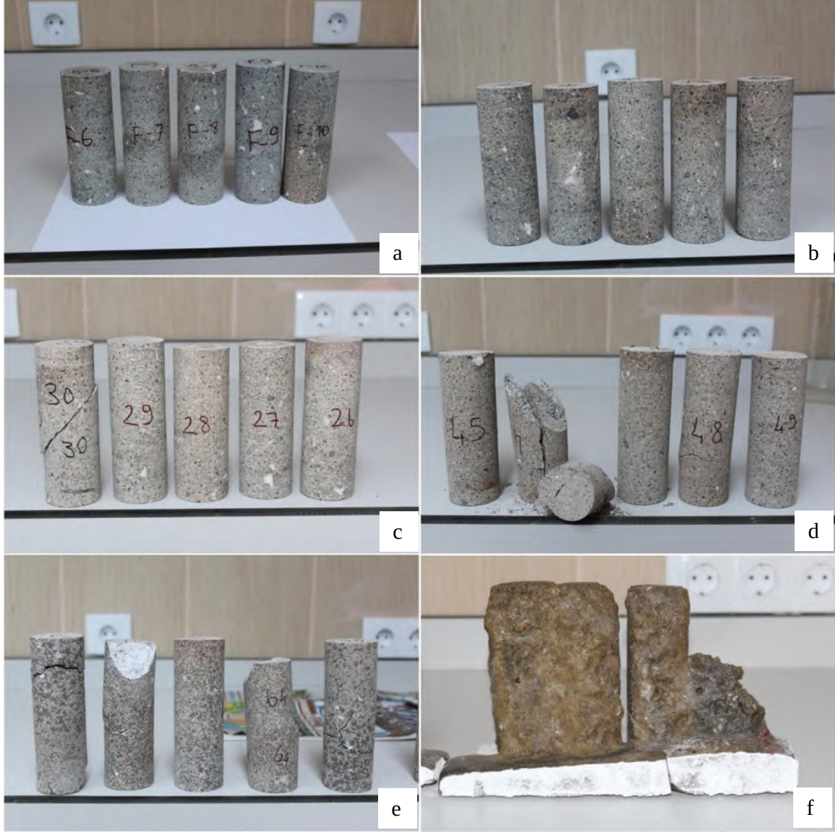
Şekil 4. Sırası ile 200 (a), 400(b), 600(c), 800(d), 1000(e) ve 1200 °C (f) sıcaklığa maruz kalmış örnekler
