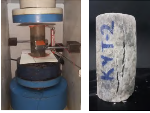
Şekil 6. D93 örneği için tipik bir \sigma - \epsilon -R davranışını belirleme deneyi ve deney sonrası kırılmış örnek.
