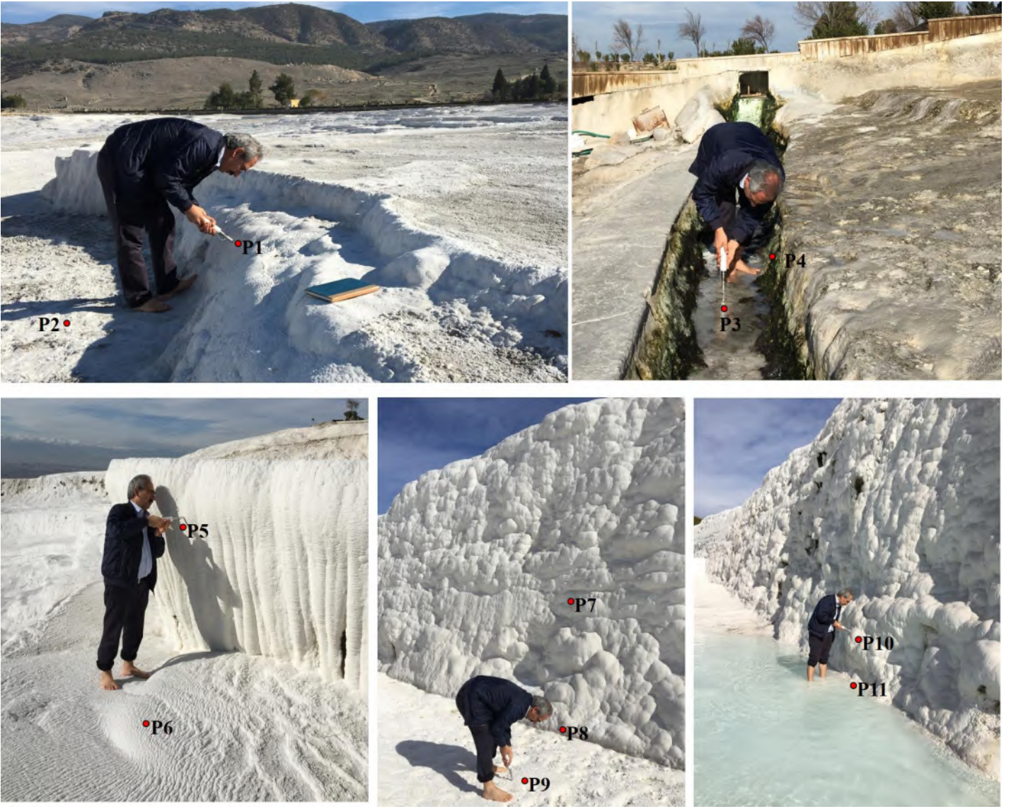
Şekil 8. Pamukkale güncel travertenlerinin farklı çökeltim ortamlarında iğne penetrometresi deneyi uygulamasının görünümü.
