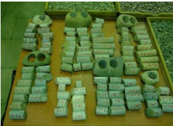
Şekil 4 Deneyler için hazırlanan silindirik kaya numuneleri.
