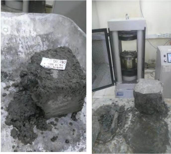
Şekil 2. test sonucu beton örneklerin kırılma şekilleri
