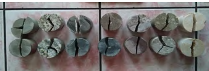
Şekil 10 Nokta yükü dayanım indeksi deneyi sonucu kırılmış numuneler.
