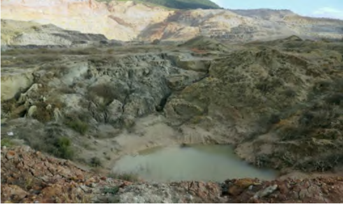
Şekil 12. M Panosu üzerinde bulunan tasman çukuru.
