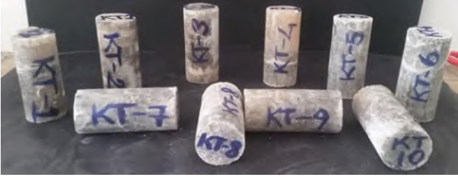
Şekil 2. Ölçek etkisini belirlemek amacıyla H/D=2 koşulunda hazırlanan tipik D93 örnekleri.
