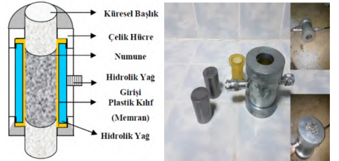
Şekil 4. Üç eksenli basınç deney hücresinin (Hoek Hücresi) şematik gösterimi ve görünümü (Çınar, 2007, Kantarcı, 2017)
