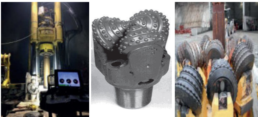
Atlas Copco 73RH C BDM, Kılavuz delgi matkabı, genişletme kafası.
