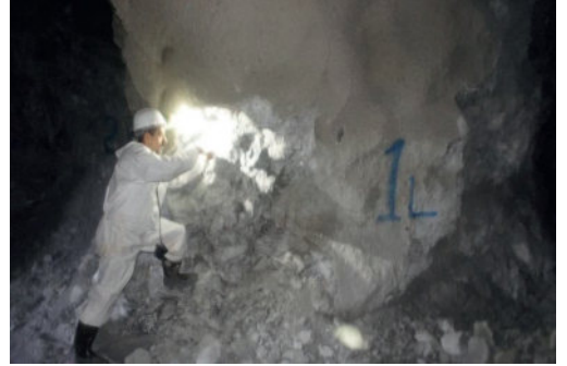
Şekil 3. Yerinde Schmidt sertliği belirleme deneyi
