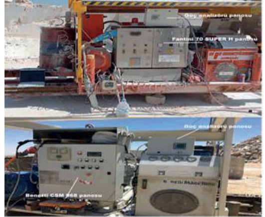
Şekil 3 Güç analizörü için hazırlanan panonun zincirli kesme makinelerinin elektrik panolarına bağlantısı (Candemir, 2021)
