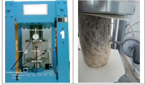
Şekil 4. Sünme deney düzeneği ve test edilen tipik bir örnek.
