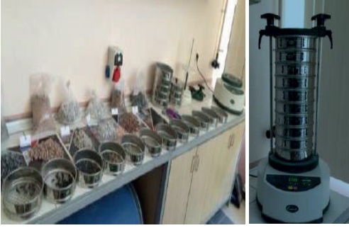
Şekil 4. Kırılabilirlik indeksi tayini için kullanılan elek serisi
