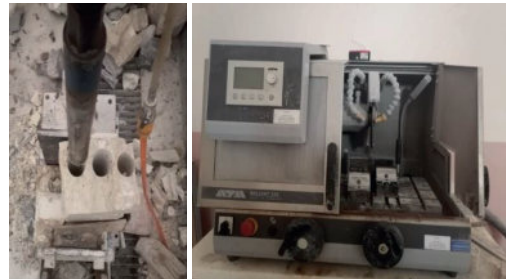
Şekil 2. Karot alma makinesi (solda), numune kesme ve düzeltme makinesi (sağda).
