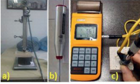
Şekil 1. (a) C-2 tipi Shore Scleroscope'u, (b) L-tipi Schmidt çekici, (c) Leeb sertliği ölçüm cihazı (Akbay vd., 2021)
