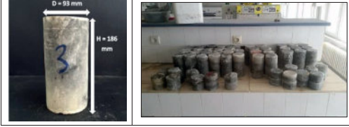
Şekil 3. H/D=2 ve D=93 mm koşulunda hazırlanan örnekler.
