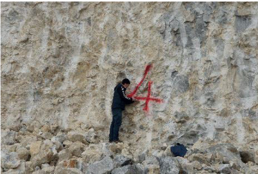
Şekil 3. Yerinde Schmidt sertliği belirleme deneyi.
