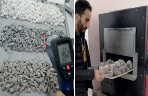
Şekil 3. Numunelerin mikrodalga maruz bırakılması ve sıcaklıklarının ölçülmesi
