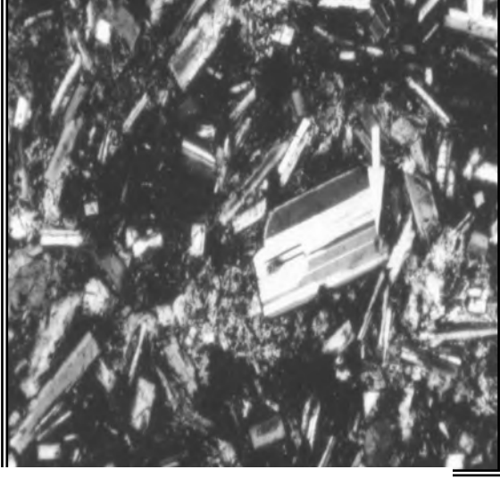
c. Plajiyoklas Feldispatlarda gözlenen polisentetik ikinlenmeler ve seri dokusu
