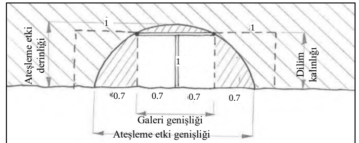
Şekil 3 Galerî ateşlemesi etki alanı
