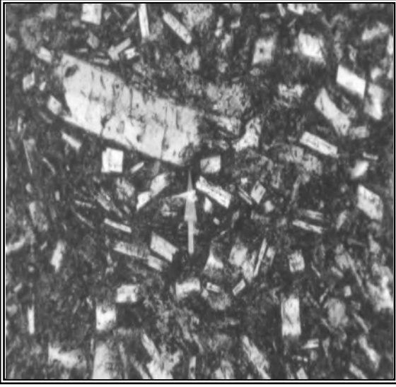
a. Kesitlerin içerisinde gözlenen idiomorblastik dokulu plajiyoklaz kristalleri
