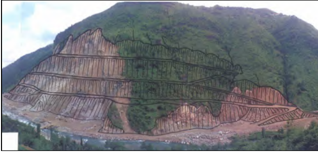
Şekil 26 Taş ocağında kademeli işletme sisteminin tüm taşocağı sahasına tatbik edilmiş halinin son görünümü
