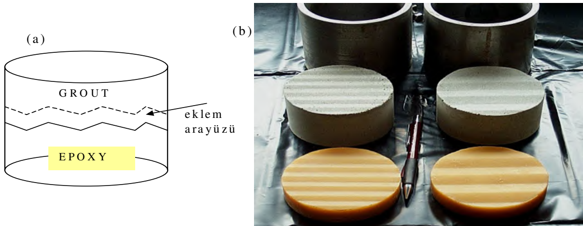
Şekil 1 (a) Süreksizlik örneklerinin döküm işleminin şematik gösterimi (b) Metal silindirlerin, hazırlanmış örneklerin kalıplı (grout) ve reçine (epoxy) kalıplarının fotoğrafı (üstten alta doğru)
