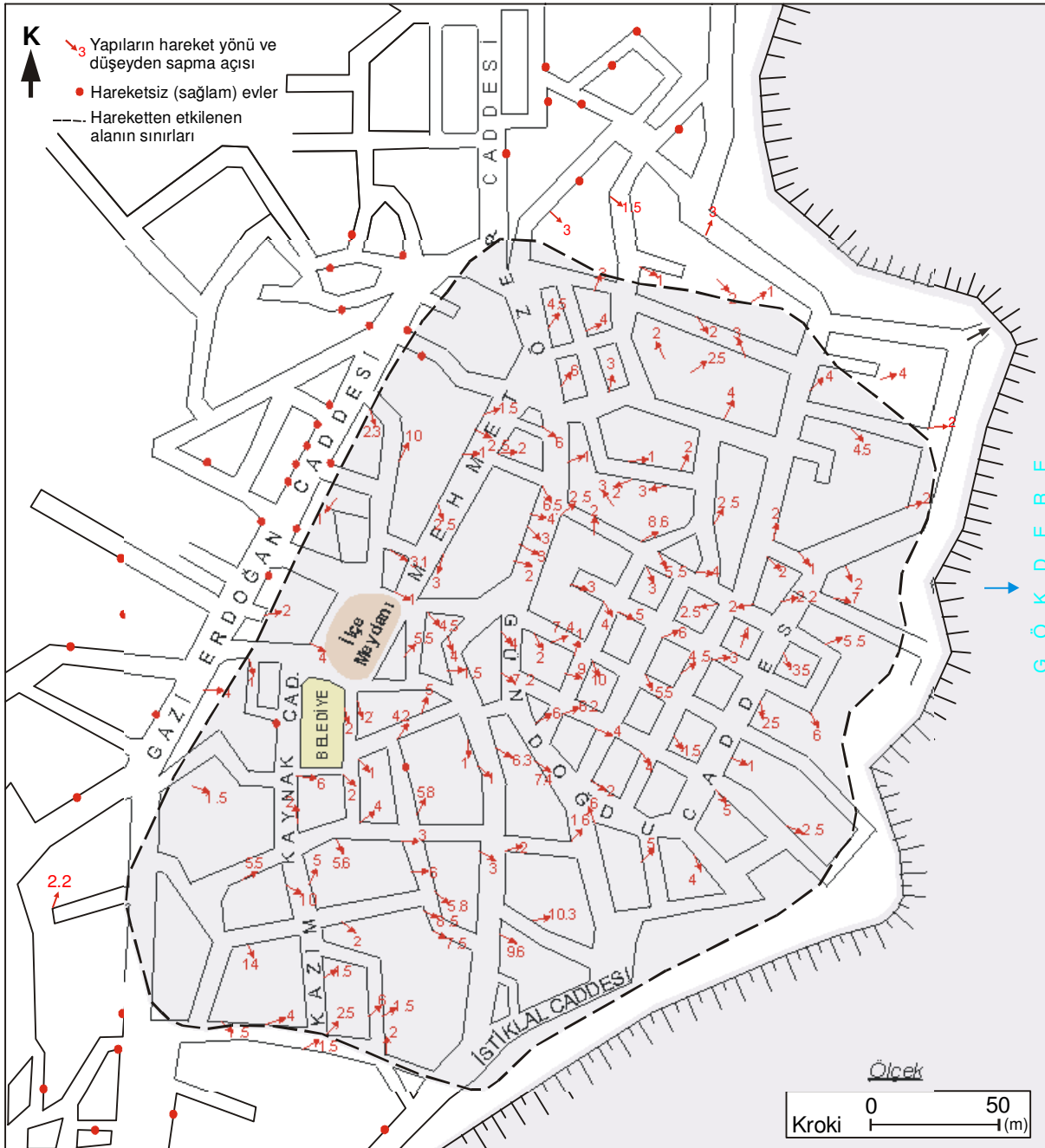
Şekil 7 Binalardaki deformasyon ölçümlerine göre belirlenen hareket yönleri ve duraysız alanın sınırları
