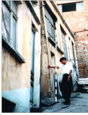
Şekil 6 Bina duvarlarından alınan ölçümlerle düşeyden sapmanın ve hareket yönünün belirlenmesi
