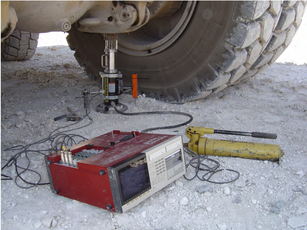
Şekil 2 Plaka yükleme deneyi
