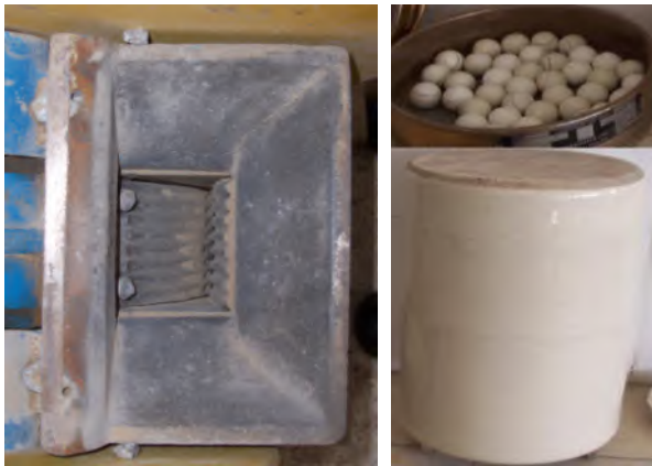
Şekil 2 Çeneli kırıcı ve bilyalı değirmen
