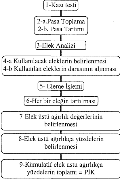
Şekil 4. Pasa irilik katsayısının belirlenişi
