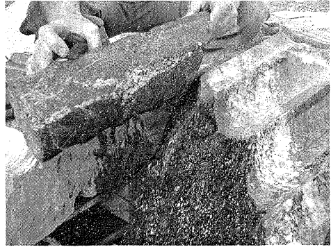
Şekil 1. Doğrusal kesme deneyi için tünel yan aynasından alınan kaya bloğu ve laboratuvar deneyleri ( \sigma_c ; \sigma_t ; CAI; KI) için bloktan alınan karot
