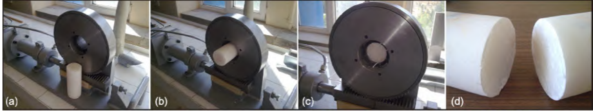
Şekil 8. Karot boğma deneyinde yenilmenin gerçekleşmesi ve yenilme yüzeylerinin görünümü.
