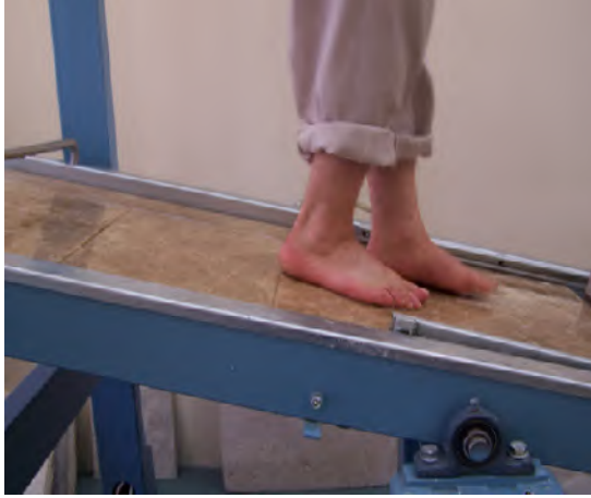
Şekil 2. Çıplak ayak ile kaplama malzemesi yüzeyi arasındaki sürtünme katsayısı ( \tan \theta = F_h/F_v ) Fig.2. Coefficient of friction (COF) between a barefoot and floor interface ( \tan \theta = F_h/F_v )
